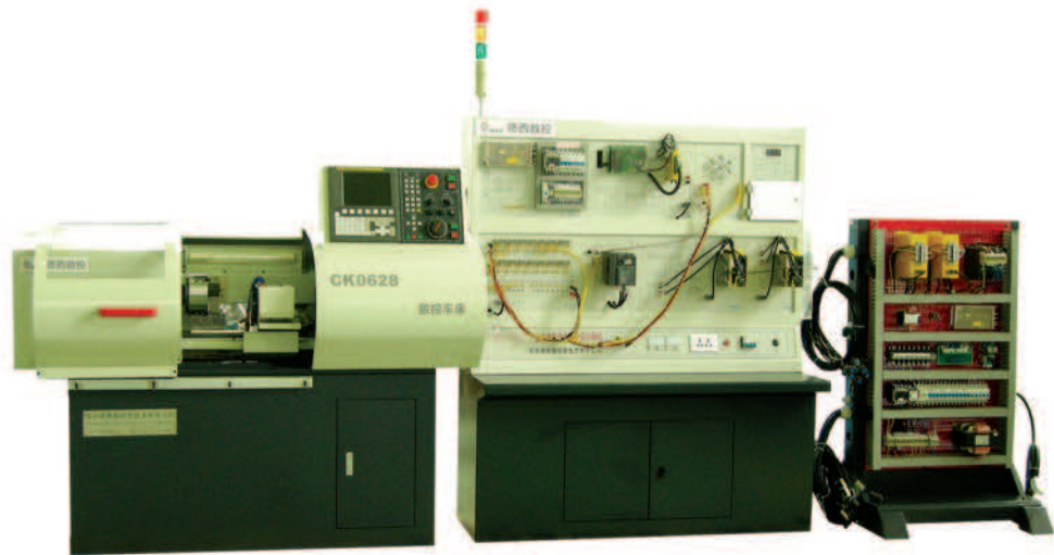
DS-R1-E (Ro) 数控车床装调维修实验实训装置
